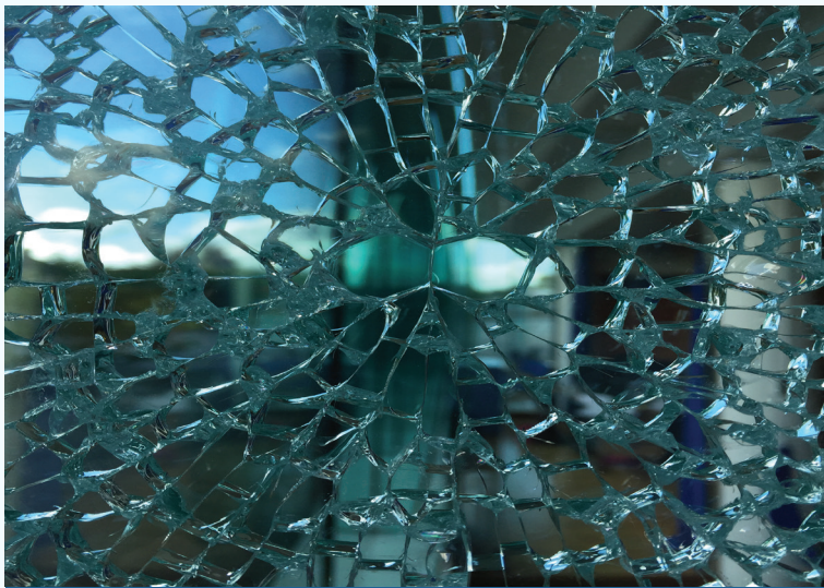
זכוכית מחוסמת לאחר היווצרות שבר ספונטני ניתן לזהות את "הפרפר" בשבירה, המעיד על שבר ספונטני
